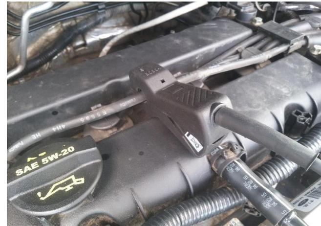
*Imagen 46 Pinza conectada al cable del cilindro 1 del motor.*
