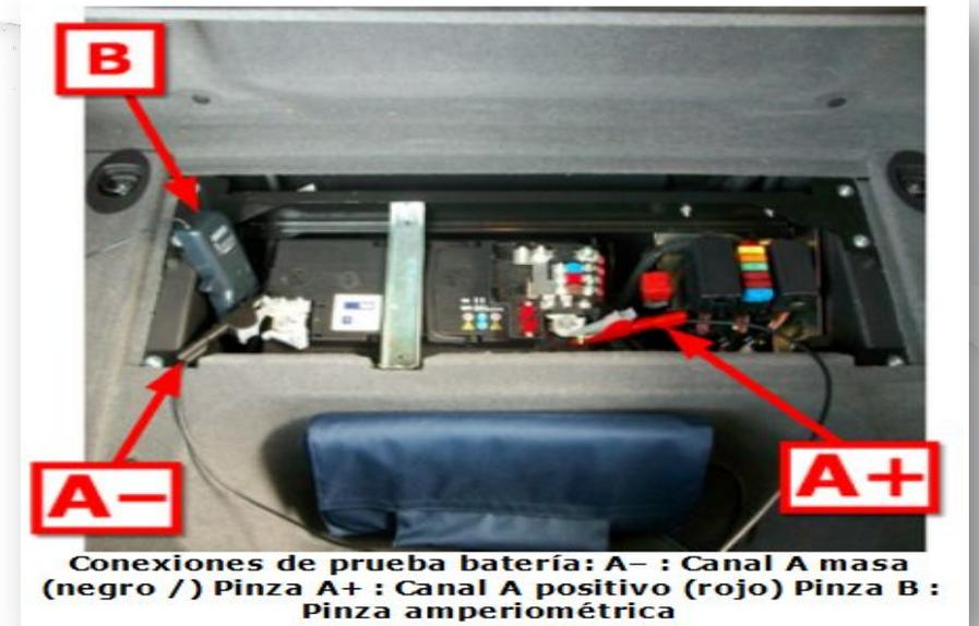
**Nota:** Por favor validar que la pinza Amperimétrica esté conectada de forma correcta “salida o entrada de corriente”
