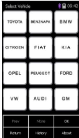
Después del ajuste, haga clic en " **Diagnóstico a través de Bluetooth**" el sistema entrará en interfaz de selección de modelo del vehículo. Si se ha configurado el Bluetooth por defecto, el sistema entrará directamente a la interfaz de selección de vehículo.
