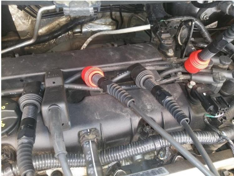
Imagen 57 Cables de alta tensión conectados
