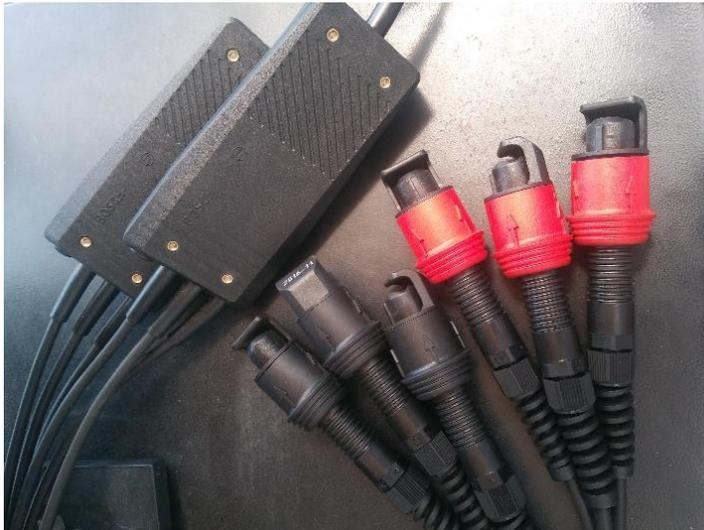
Imagen 55 Cables de alta tensión para circuito secundario.
