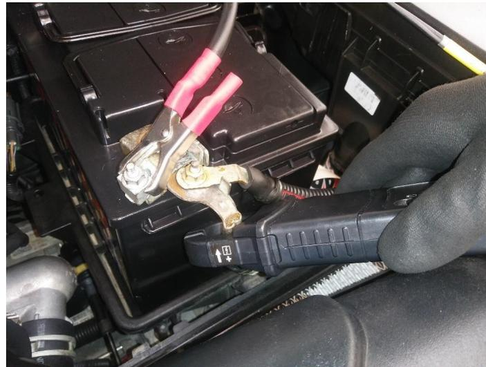
**5.3.6** Verifique que la pinza quede completamente cerrada, esto con el fin de poder tener una buena lectura de datos. Adicional a esto, haga la puesta a cero de la pinza (*Ver imagen 11*).
