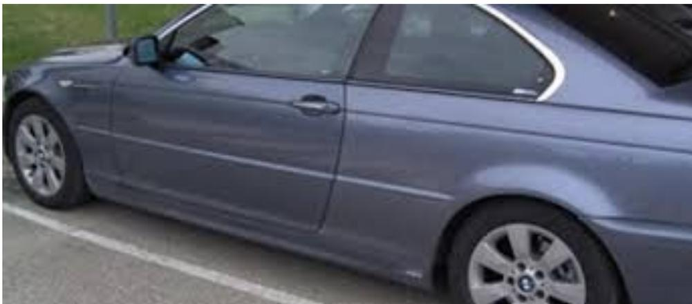
**Diferentes tonos de pintura :** se realiza un proceso de preparación de la pintura para los repintados parciales y se evidencian diferentes tonos de pintura
