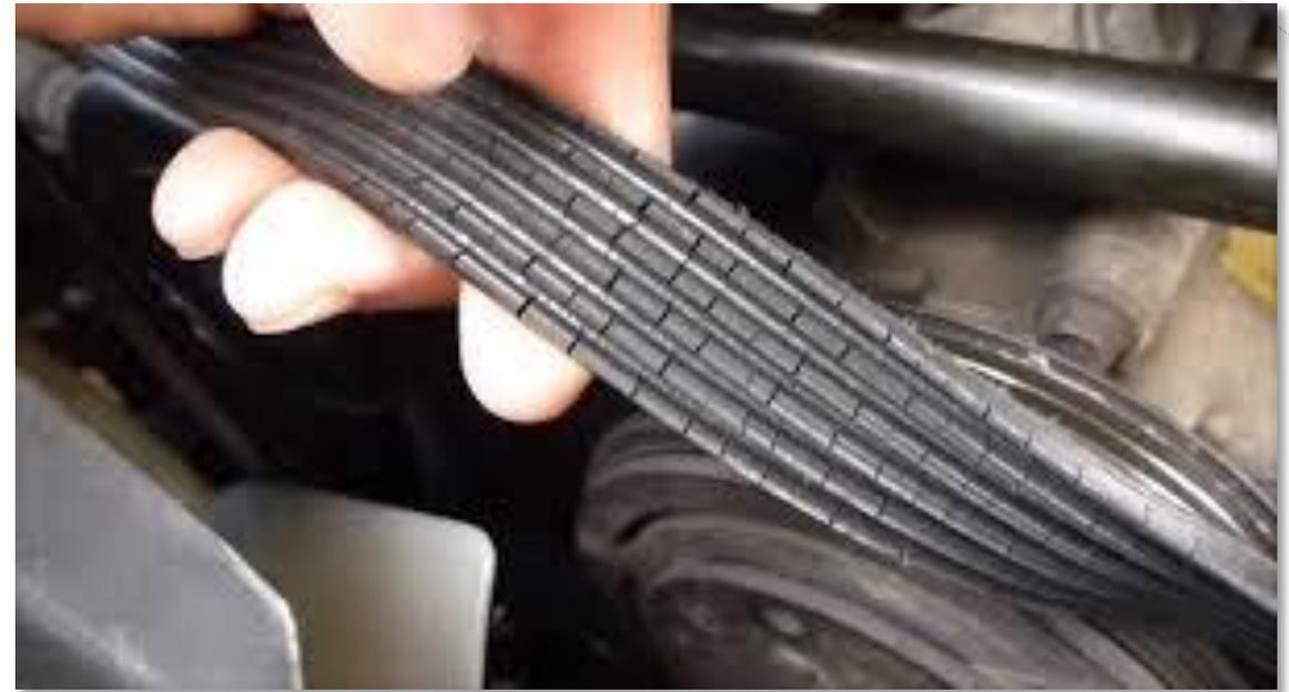
Validar que la correa no presente cortes o grietas por exceso de temperatura o por agotamiento de material
