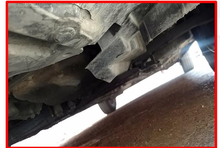
No se observa corrosión en las piezas dentro de la foto
