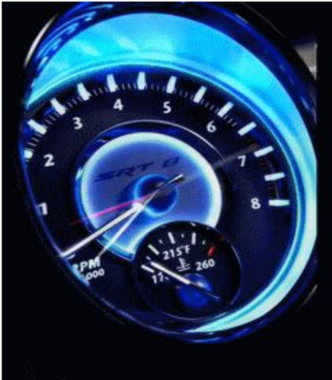
Verificar su estado y al acelerar el vehículo su funcionamiento debe ser coherente con las revoluciones del vehículo.
