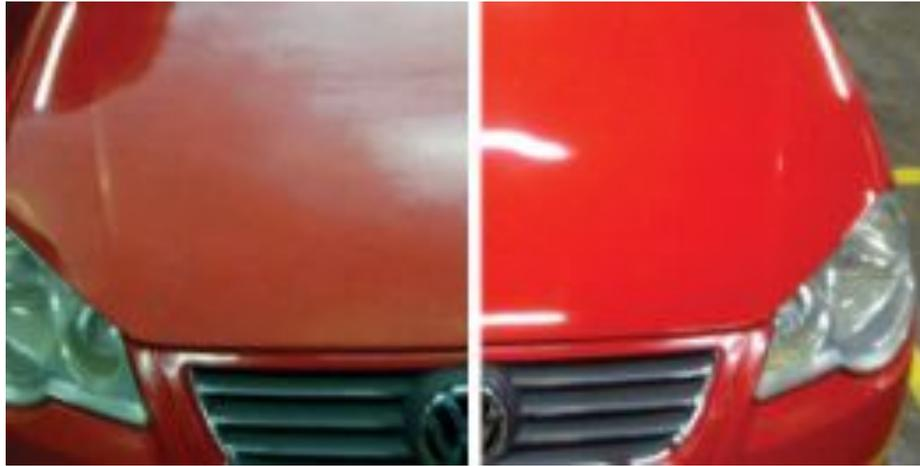
**Pérdida de brillo:** Superficies mates o matizadas, el brillo de una pintura se aprecia por el reflejo de un objeto en la superficie, esto se da porque los materiales utilizados en la reparación no son de buena calidad.
