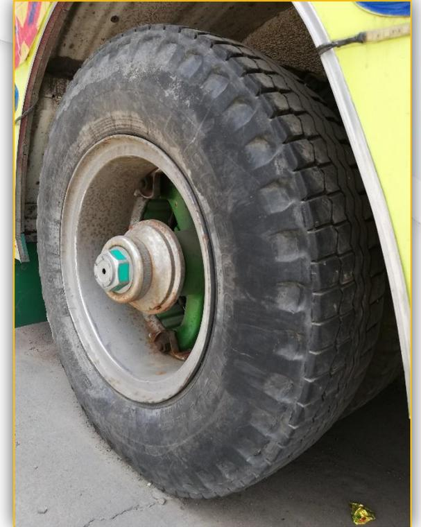
Sin embargo no todas las llantas son aptas para el reencauche, se estima que entre el 10% y 17% son rechazadas por diversos motivos: desgaste excesivo de la banda de rodadura, daños o perforaciones producto del trabajo pesado, por un mantenimiento inadecuado o simplemente no fueron diseñadas para este proceso
