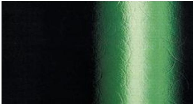
**Marcas de lijado:** Las rayas de lijado se presentan como estrías en la pintura de acabado, se da por mal alistamiento al momento de la aplicación del aparejo.
