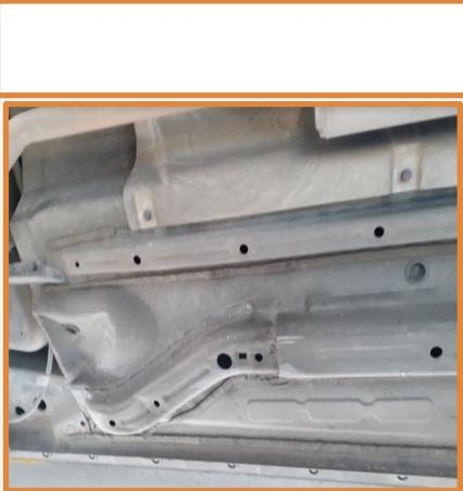
En la imagen se observa el piso de la carrocería en parte delantera lado izquierdo y derecho, con refuerzo piso.
