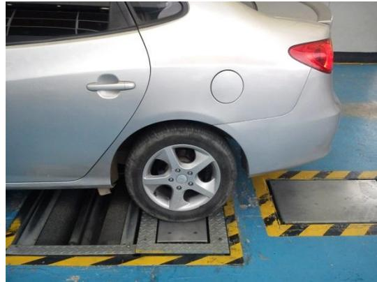
**Prueba de suspensión eje trasero:** Con el vehículo ubicado en los platos y atendiendo la indicación del software, espera la culminación de la prueba y se dispone a ubicar el eje trasero del vehículo en los rodillos.
