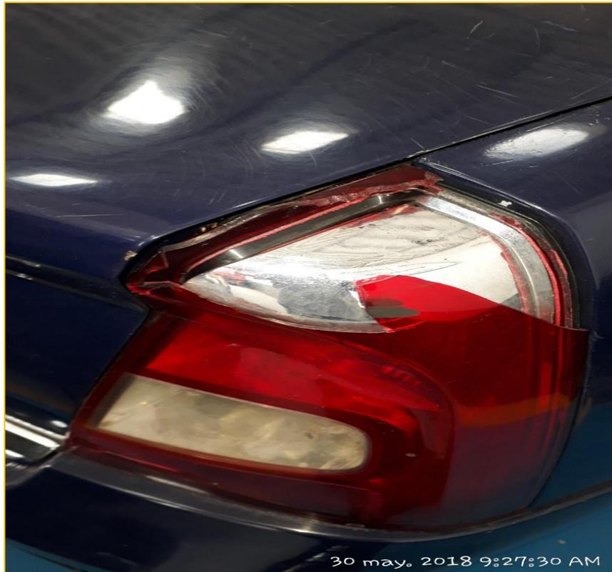
**Rotura Fuerte:** Se selecciona cuando la pieza presenta desprendimiento de material por rotura. No importa la magnitud del área rota
